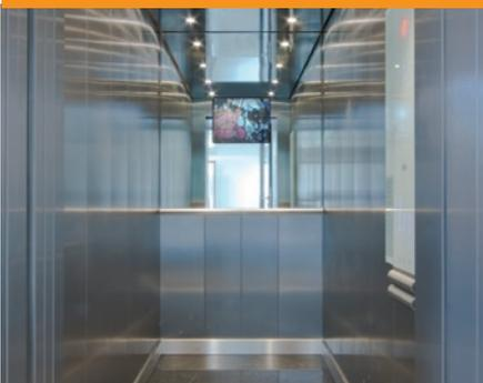
**Aufzugstyp 1, 2 und 3** müssen mit einem Spiegel oder einer ähnlichen Anbringung ausgestattet sein, die das Erkennen von Hindernissen, die sich vor den Schachttüren befinden könnten, bei dem Rückwärtsfahren mit Rollstühlen ermöglicht.
